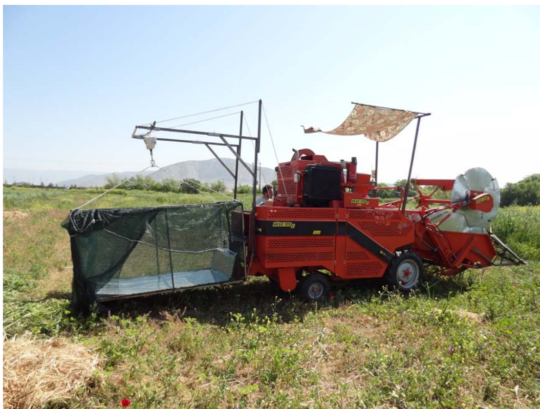
Σχήμα 1. Θεριζοαλωνιστική πειραματικών τεμαχίων πλάτους 1,5m (HEGE 125c). Η βιομάζα συλλέγεται στο αναρτώμενο καλάθι πίσω, όπου ζυγίζεται το χλωρό βάρος..
