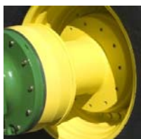
Σχήμα 7. Προσθήκη εξαρτημάτων για αύξηση του εύρους των τροχών γεωργικού ελκυστήρα.
