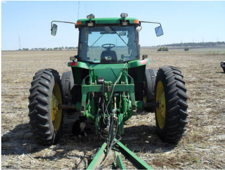
Σχήμα 9. Ελκυστήρας με εύρος τροχών 3 μέτρα.
