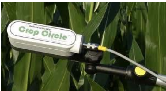
Σχήμα 6. Όργανο μέτρησης φυλλικής επιφάνειας Crop Circle.
