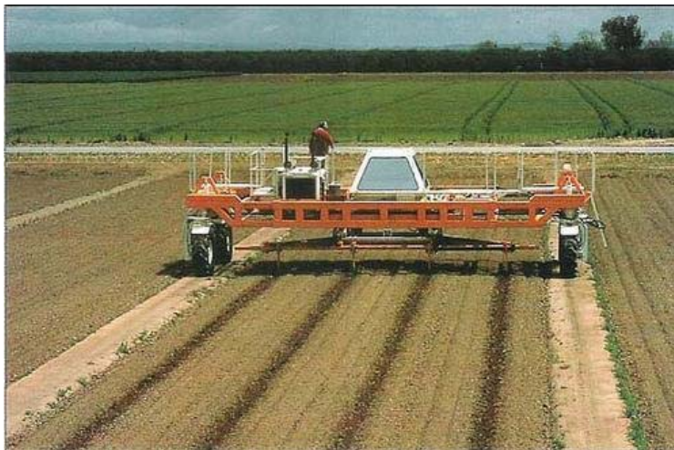
Σχήμα 10. Ελκυστήρας με μεγάλο άνοιγμα τροχών (Gantry)
